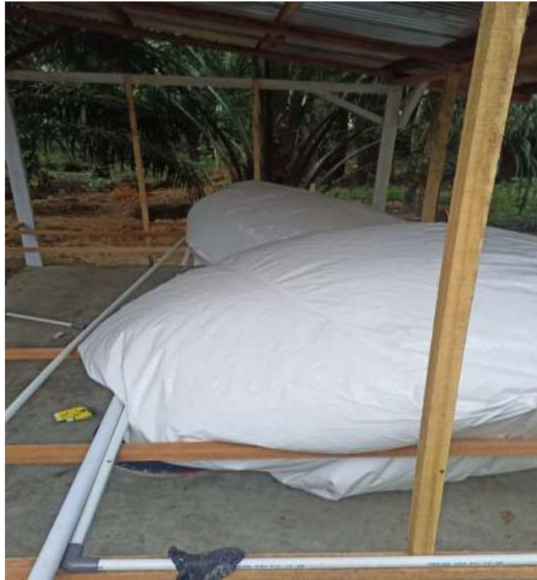
Gambar 21 pembentukan awal gas biogas
