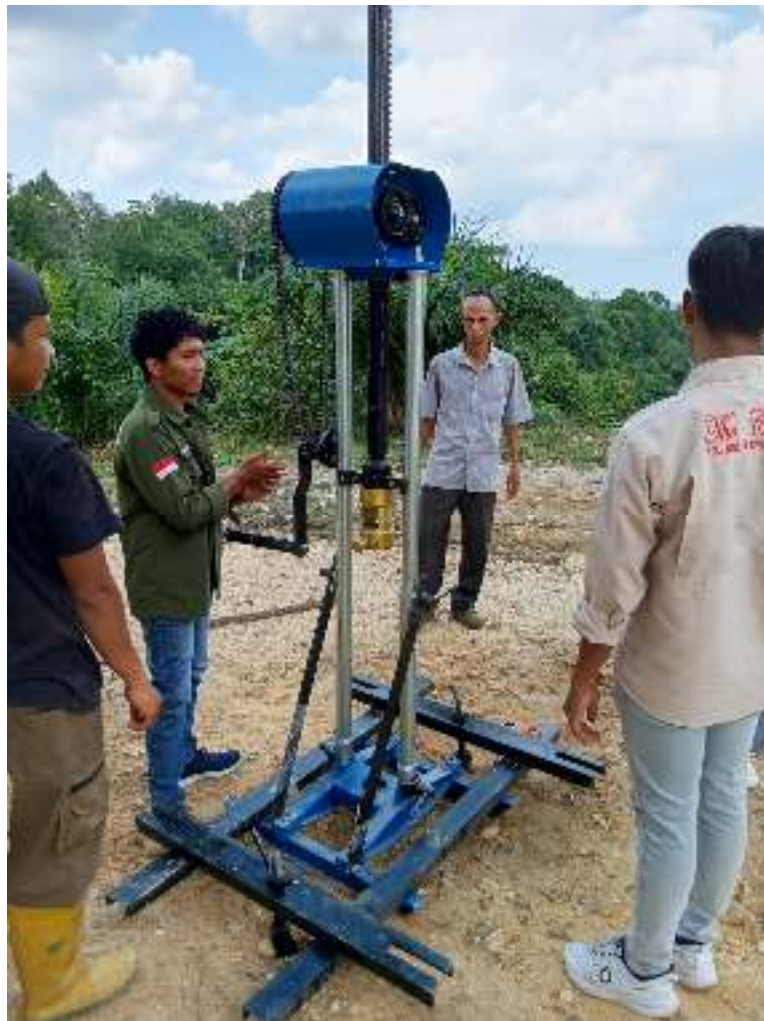
Gambar 4. Alat uji sondir kapasitas 2,5 Ton
