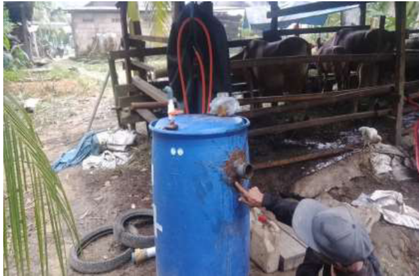
Gambar 4. Reaktor yang gagal menghasilkan gas metana
