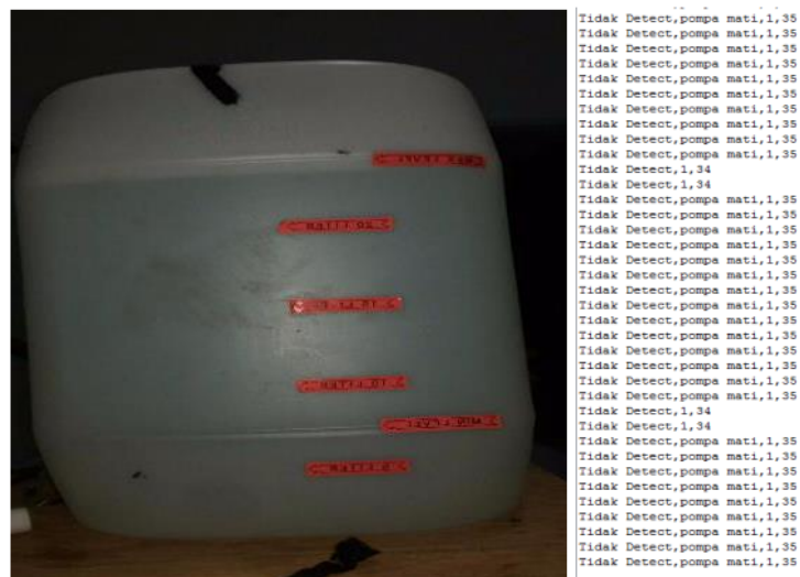
Gambar 4.7 (a) air berada dilevel maksimum tangki, (b) data yang terbaca oleh Arduino
