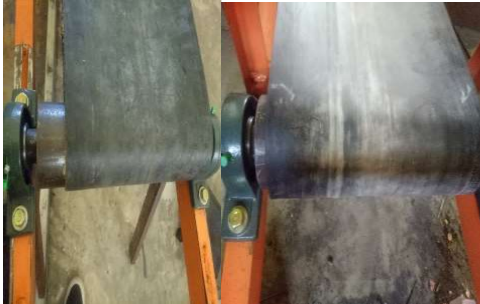
Gambar 4. 4 Roller depan dan roller belakang
