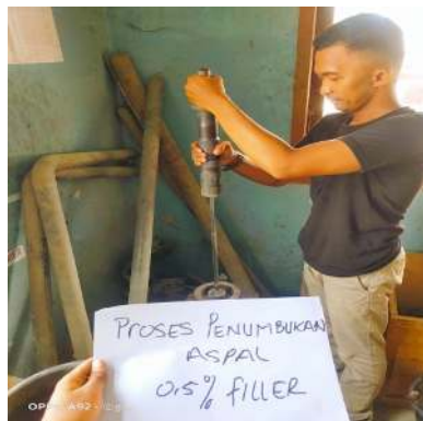
Gambar 8. Proses Pemadatan Benda Uji
