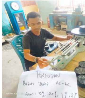
Gambar 10. Proses Penimbangan Benda Uji
