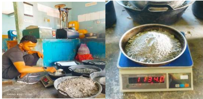
Gambar 4. Proses Penimbangan Bahan Penyusun Benda Uji
