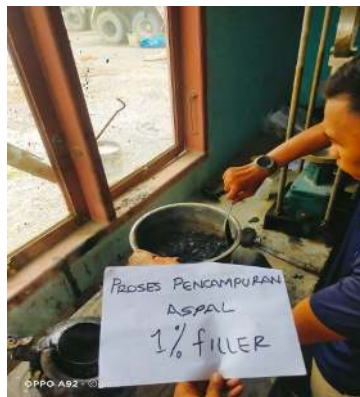
Gambar 6. Pencampuran Bahan untuk Benda Uji
