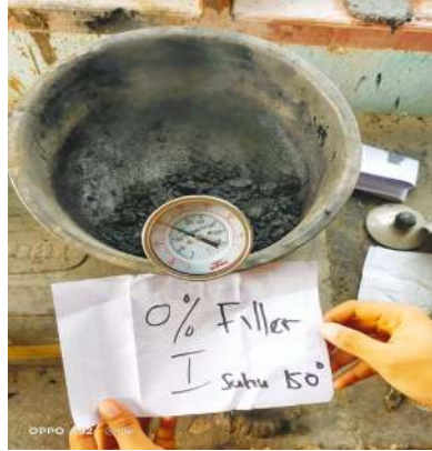
Gambar 7. Kontrol Suhu Pencampuran
