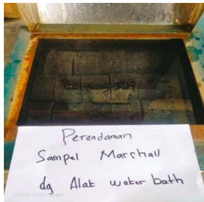
Gambar 15. Perendaman Benda Uji di Water Bath
