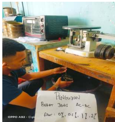
Gambar 13. Proses Penimbangan Benda Uji di dalam Air
