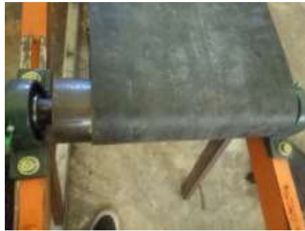
Gambar 4. 4 Roller depan dan roller belakang
