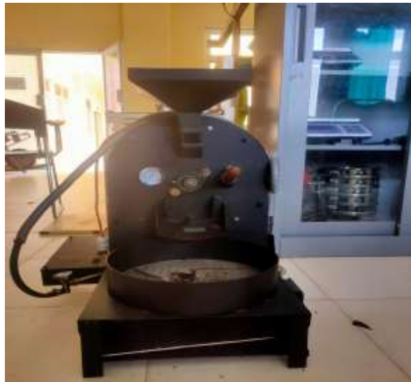
Gambar 4.3 mesin sangrai kopi tampak depan
