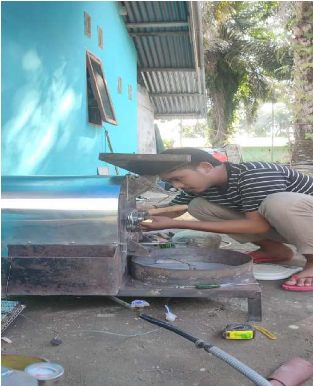
Gambar Pemasangan Rangka Luar
