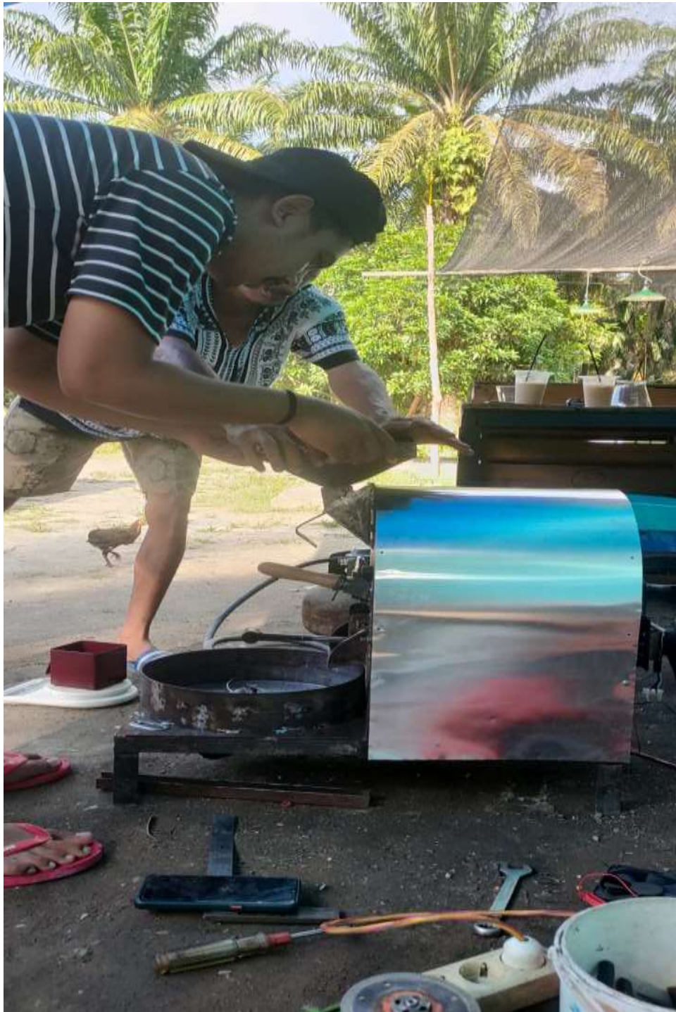
Gambar Proses Pemasangan Hopper
