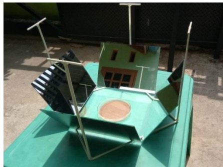
Gambar 9. Susunan rangkaian alat fotoreaktor batch dengan alas Bambu yang dicoating dengan \text{TiO}_2 dengan tambahan cermin
