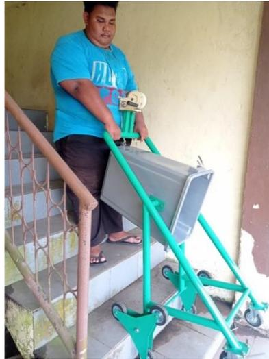
**Gambar 4.19** Pengujian jalan di tangga
