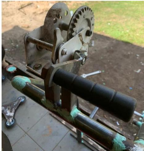
**Gambar 4.15** Proses pemasangan katrol dan tali sling
