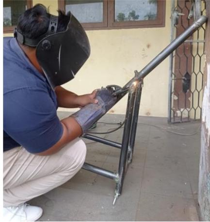
**Gambar 4.8** Pengelasan bagian rangka utama
