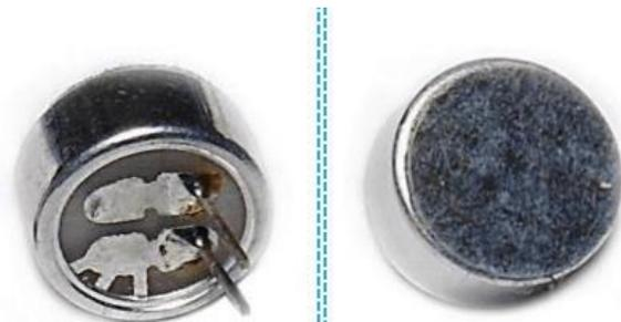
**Gambar 4.1** Bentuk Fisik *Microphone Condenser*
