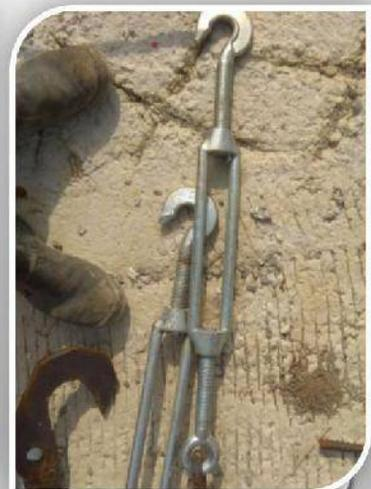
Gambar 19. Material Wind Rope Set, Seling dan Jarum Keras
