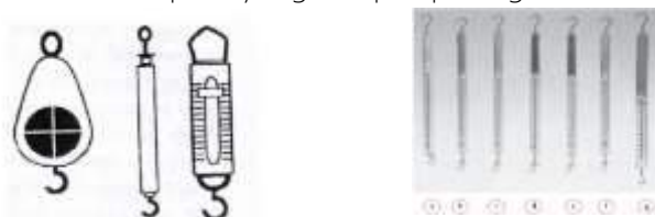
Gambar 2.2 Jenis-jenis dinamometer untuk skala (a) 0,2 N, (b) 1 N, (c) 2 N, (d) 5 N, (e) 10 N (f) 20 N, dan (g) 100 N
