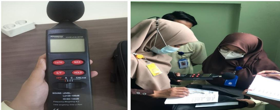
**Gambar 1.7** Melakukan kegiatan pengukuran kebisingan dengan menggunakan *SOUND METER* di beberapa ruangan di Rumah Sakit Ibnu Sina Pekanbaru, seperti Ruang Rawat Inap, Kantor, Koridor , IGD, Dapur, dll. Gambar 1. 7 Melakukan kegiatan pengukuran kebisingan dengan menggunakan *SOUND METER* di beberapa
