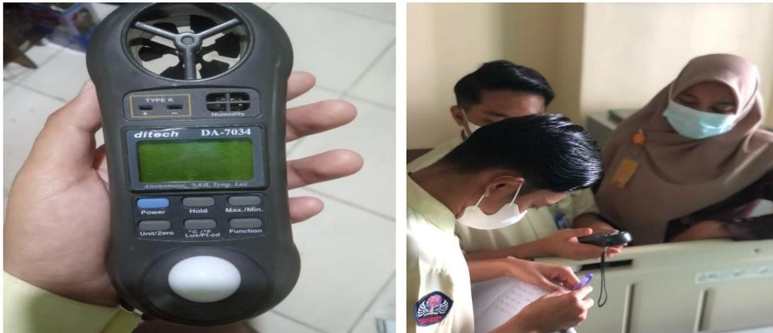
**Gambar 1. 6** Melakukan kegiatan pengukuran pencahayaan dengan menggunakan LUX METER di beberapa ruangan di Rumah Sakit Ibnu Sina Pekanbaru, seperti Ruang Rawat Inap, Kantor, Koridor, IGD, Dapur, dll.
