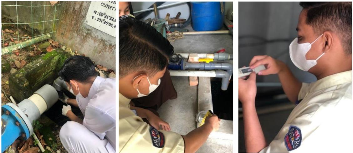
**Gambar 1. 3** Pengukuran PH Air Bersih dan Air Limbah (IPAL)
