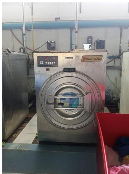
**Gambar 1. 32** Proses pencucian linen kotor non infeksius dan linen kotor infeksius. Pencucian linen kotor non infeksius menurut standar yaitu 7-10 menit sedangkan pencucian linen kotor infeksius yaitu selama 20-25 menit
