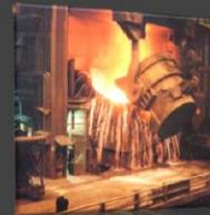
Casting adalah Proses penuangan material cair (umumnya logam cair) ke dalam suatu cetakan (mold) dengan bentuk tertentu dan mendinginkannya sampai mengeras dan menjadi bentuk sesuai dengan cetakan.
